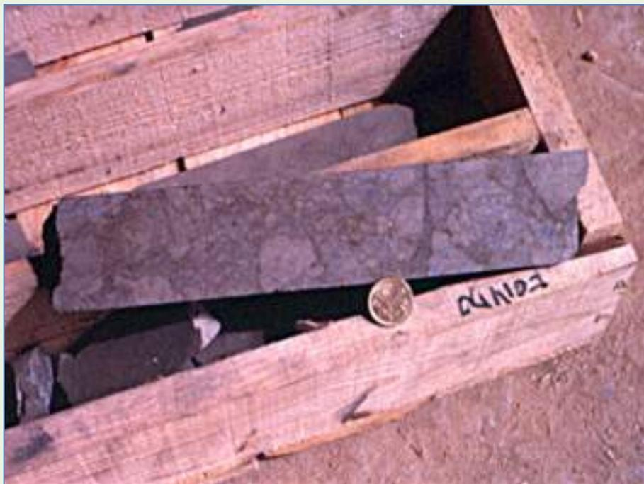
Figura 21. Masa Valverde. Mineral conglomerático, procedente de la denudación de una masa pirítica.
