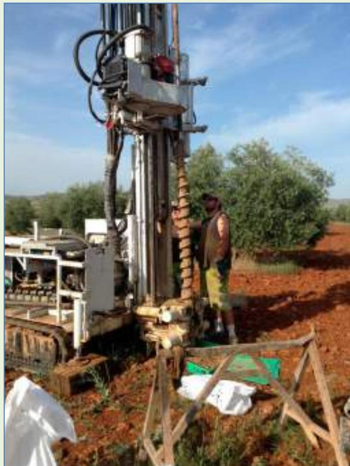
Figura 30. Realización de sondeos Augger por quantum Minería.
